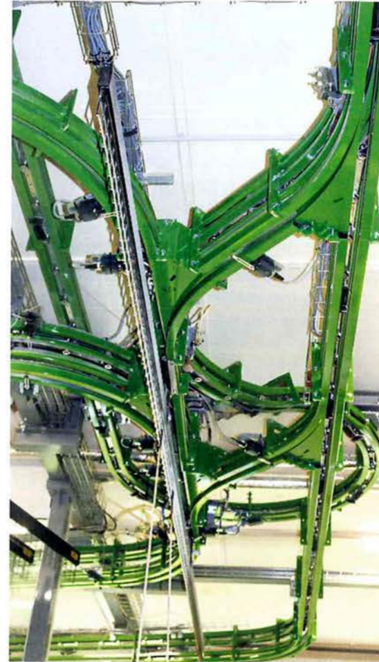
Ein ausgeklügeltes Weichensystem macht den Transport bis zu den Arbeitsstationen für die Verglasung und Beschlagsmontage möglich.
