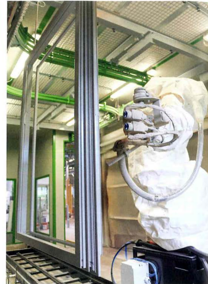
Erstmals umgesetzt wurde auch die Querförderung in der Spritzkabine. Während der Roboter die zweite Seite beschichtet, wird bereits das nächste Element eingefahren. Damit konnte gegenüber dem sonst üblichen Verfahrenprozess viel Zeit eingespart werden.
