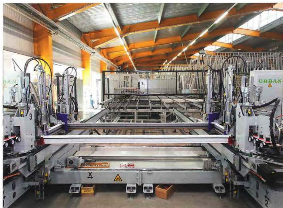
Dank der Investition in die neue Schweiß/Putz-Linie kann Sebnitzer jetzt auch Fenster mit acrylcolor-Oberfläche mit Nullfuge anbieten.
